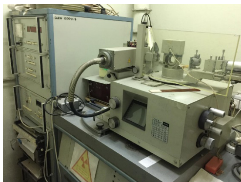
Рис. 5. Дифрактометр рентгеновский общего назначения (ДРОН-3)
