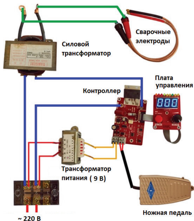
Рис. 28. Монтажная схема аппарата
