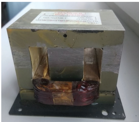
Рис. 8. Силовой трансформатор без высоковольтной обмотки
