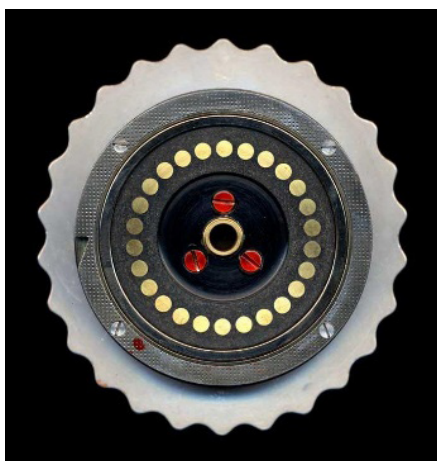
Рис. 3. Правая сторона ротора, видны штыревые контакты. Римская V идентифицирует электропроводку ротора
