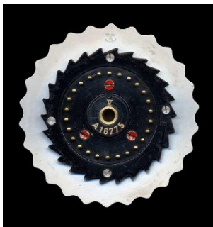
Рис. 2. Левая сторона ротора «Энигмы», видны плоские электрические контакты
