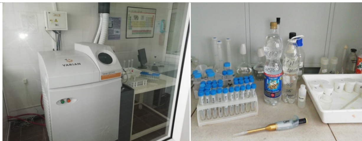
Рис. 2. Определение химических элементов в составе воды масс-спектрометрическим методом
