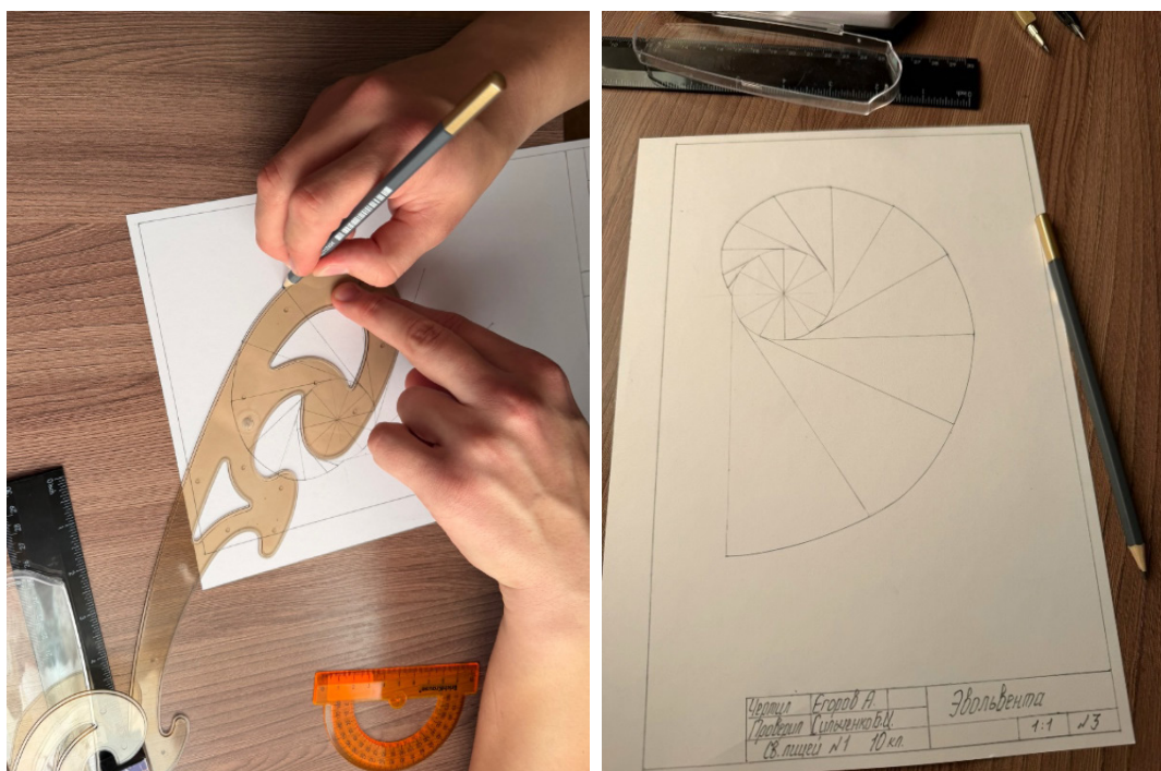
Рис. 16. Процесс построения эвольвенты и результат
