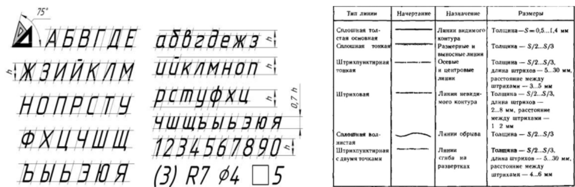
Рис. 13. Чертежный шрифт и линии чертежа
