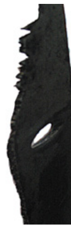
Рис. 1. Кромка лопатки турбин после эрозионного износа с существенным нарушением исходной геометрии
