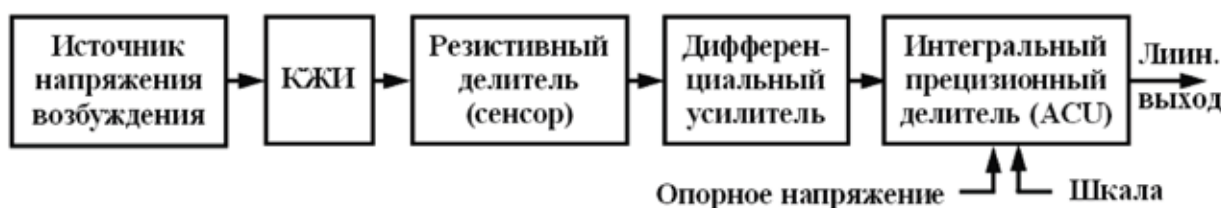
Рис. 4. Обобщенная структурная схема резистивного интегрального датчика
