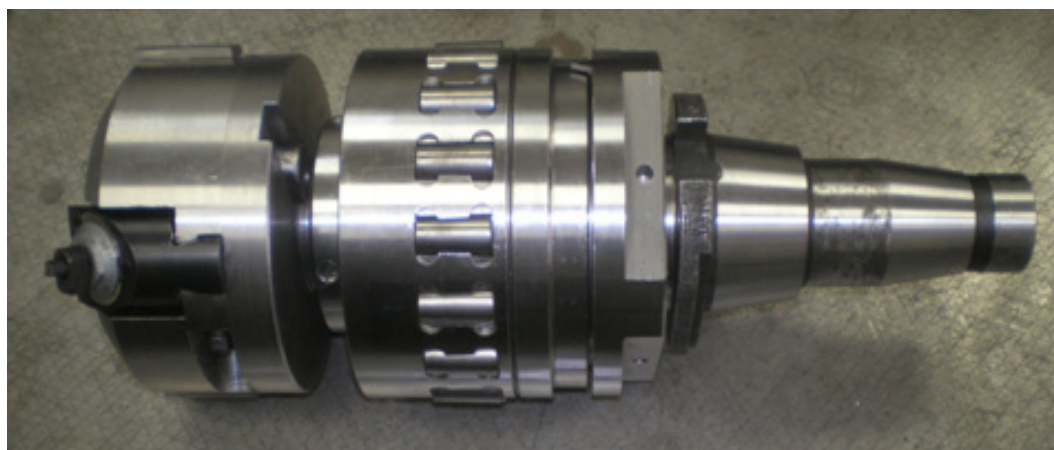
Рис. 6. Комбинированный инструмент для обработки глубоких отверстий
