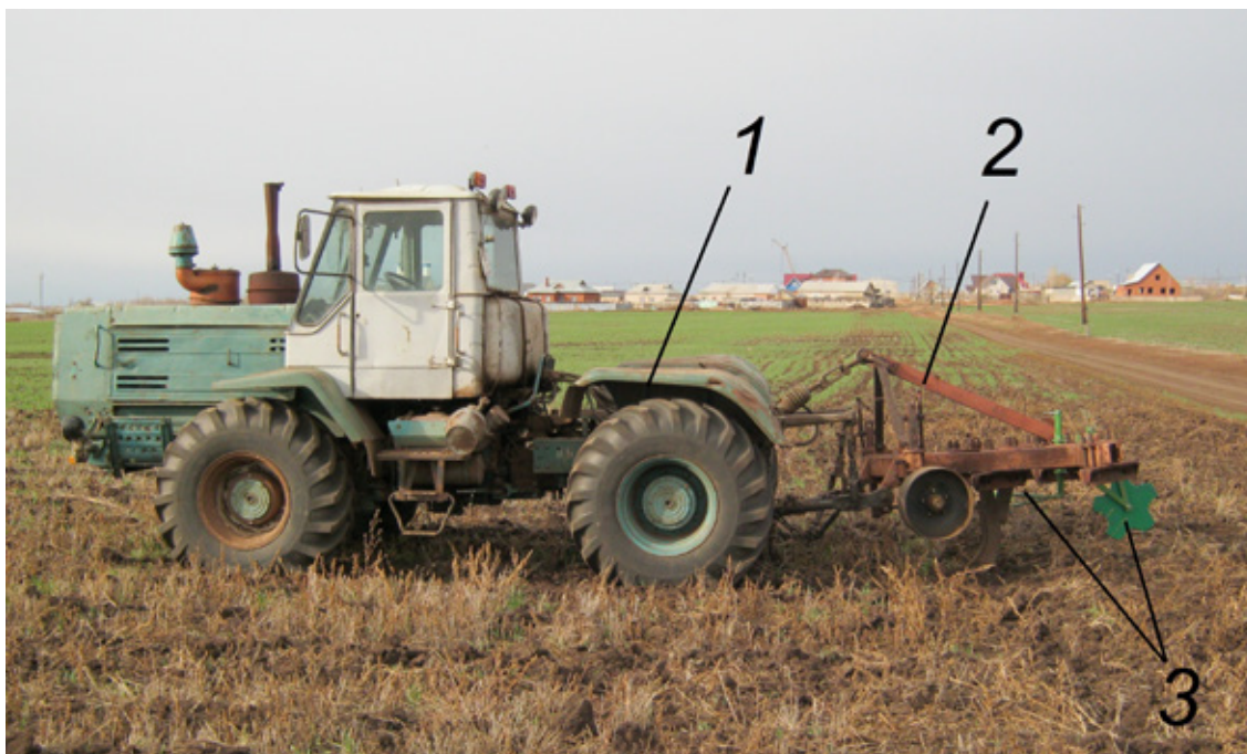
Рис. 1. Общий вид экспериментальной установки: 1 — трактор Т-150К; 2 — чизельный плуг ПЧ-2,5; 3 — экспериментальные рабочие органы
