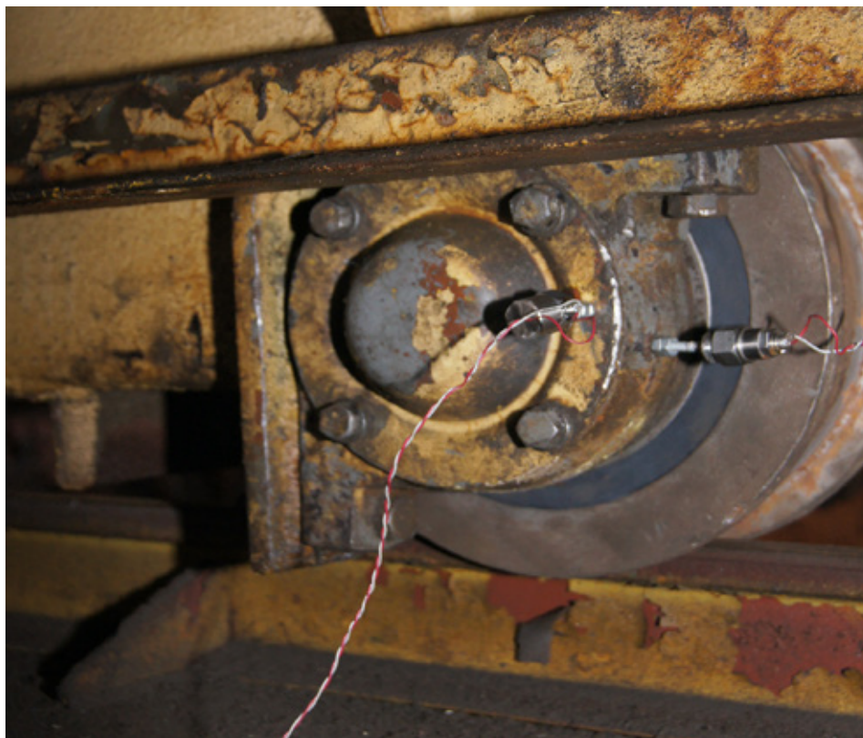
Рис. 2. Установка датчиков регистрации шума и вибрации на буксу ходового колеса тележки мостового крана
