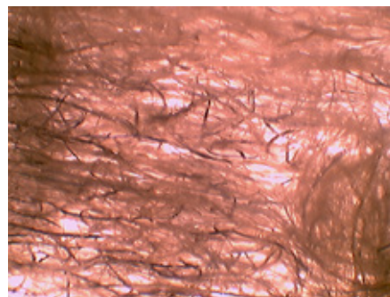
Рис. 4. Внутренняя структура нетканого материала изготовленная из смешанного волокнистого холста
