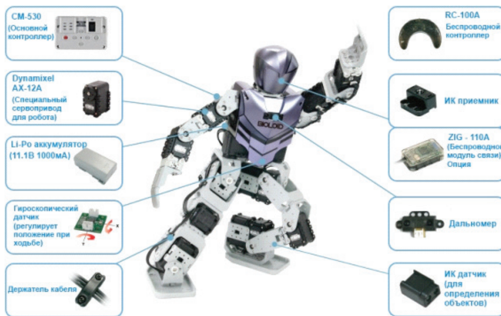
Рис. 2. Функциональная схема робота
