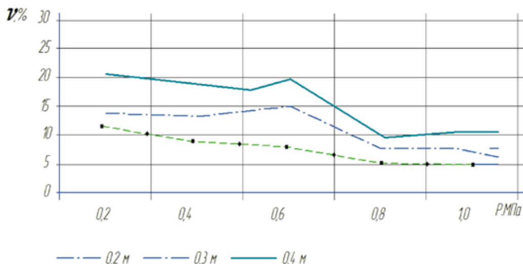
Рис. 2. Зависимость коэффициента вариации от давления в системе при различных расстояниях между распылителями
