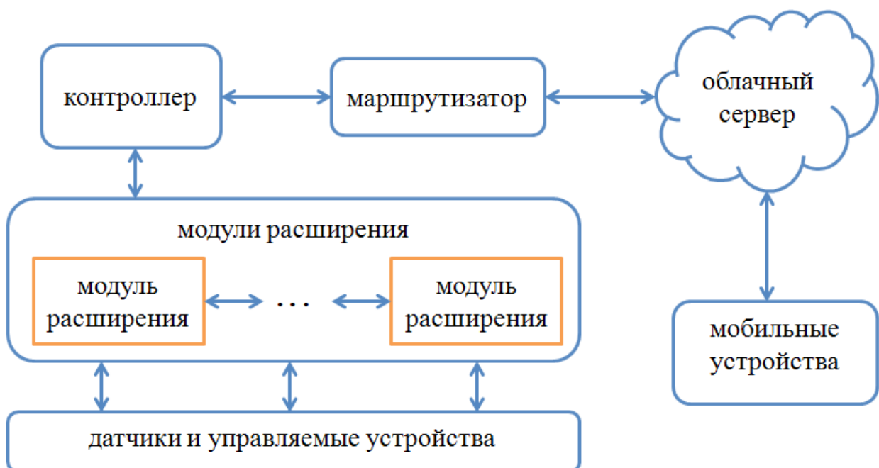
Рис. 2. Схема аппаратного обеспечения умного дома с функцией удаленного управления
