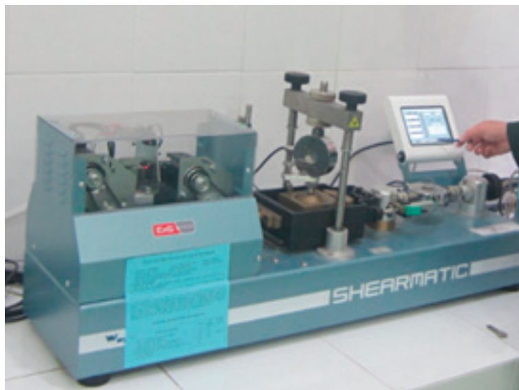
Рис. 2. Автоматический прибор прямого сдвига модели SHEARMATIC
