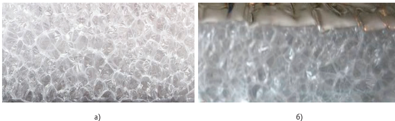
Рис. 3. Структура материалов: а) изолон; б) фольгоизолон
