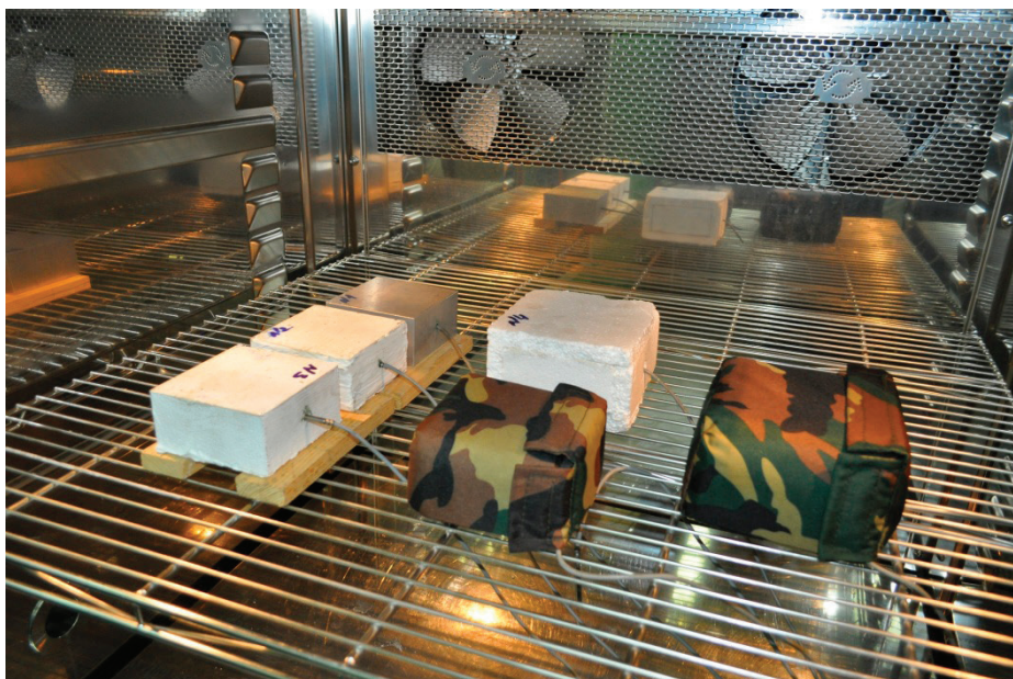
Рис. 7. Размещение образцов внутри климатической камеры
