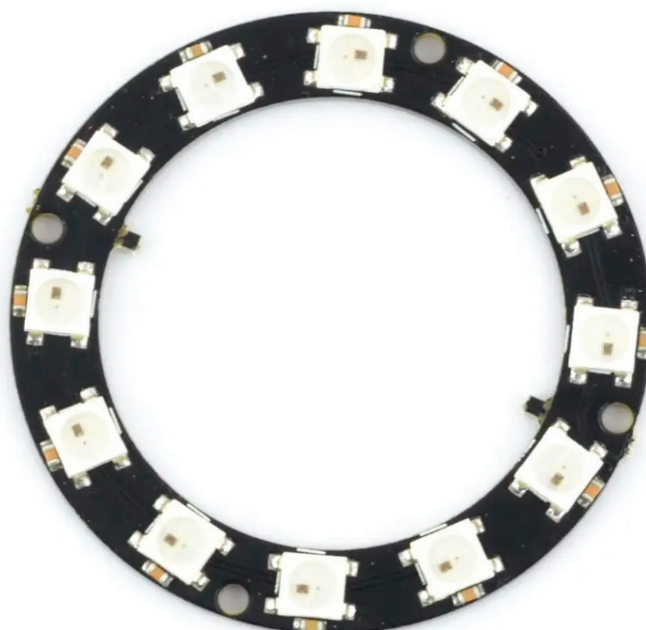
Рис. 3. Кольцо из адресных светодиодов WS2812B
