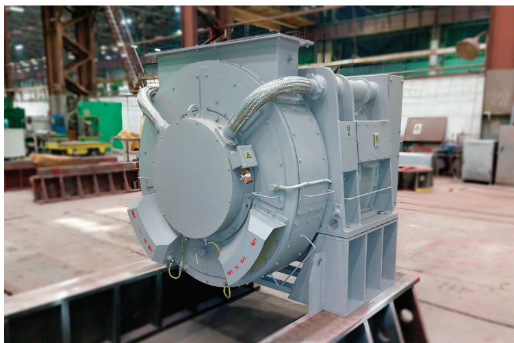
Рис. 2. Тяговый синхронный генератор ГСТ-3505–1800 У2
