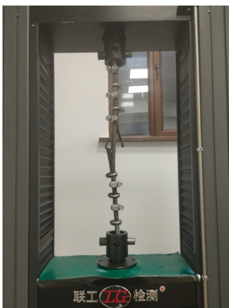
Рис. 5. Диаметр — 16 мм. Испытание каната ЛК-РО 6х36 (1+7+7/7+14) + 7-7(1+6) с помощью пресса
