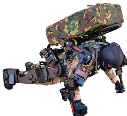
Рис. 2. Экзоскелет с активным приводом
