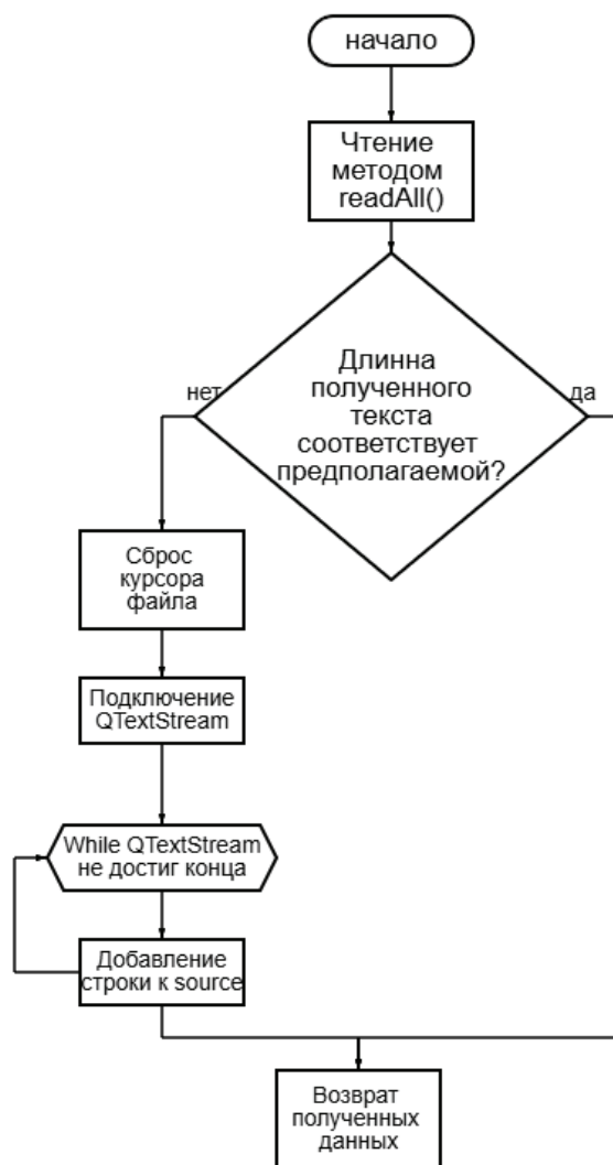
Рис. 1. Блок-схема полученного алгоритма чтения файлов
