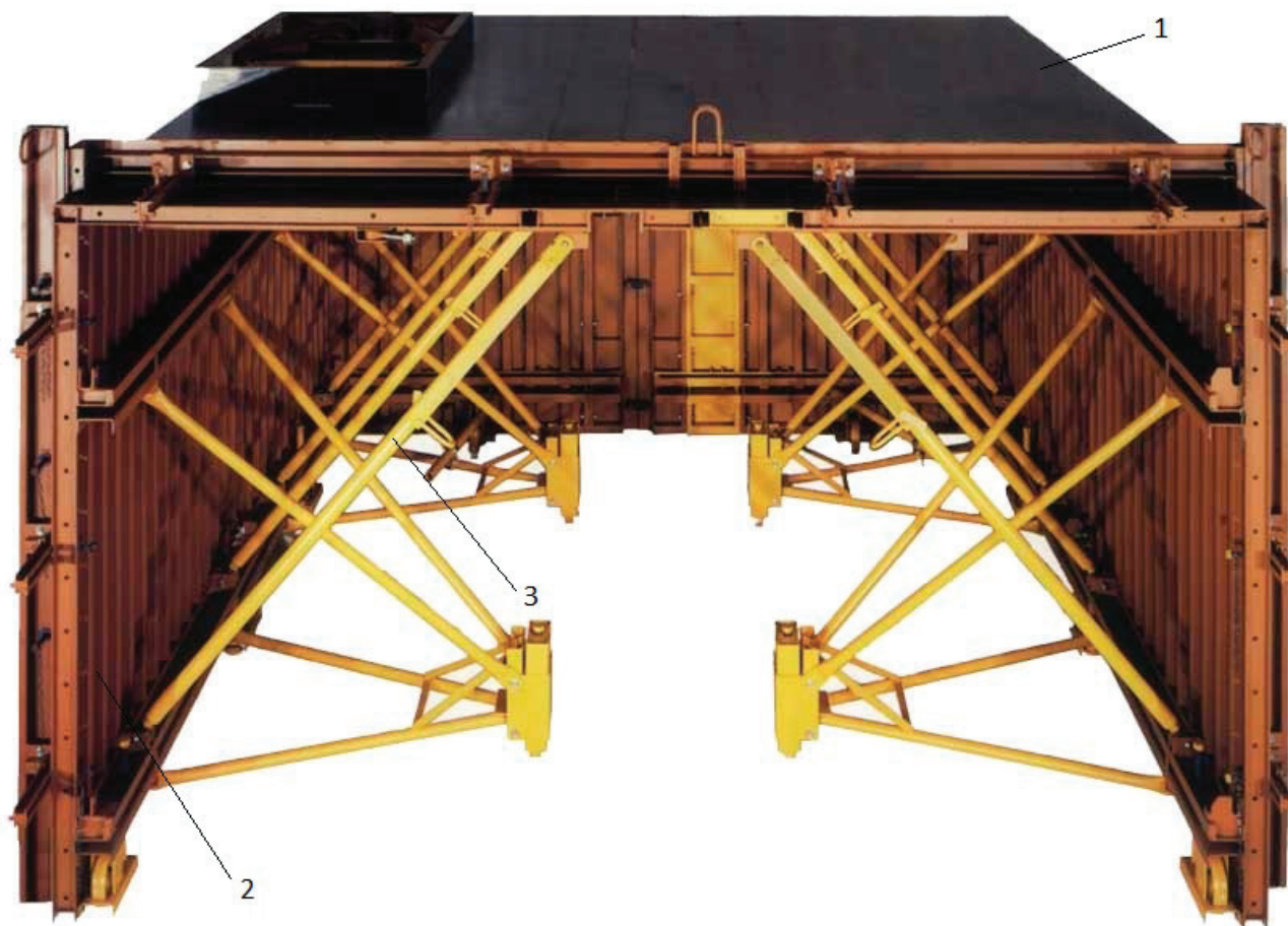
Рис. 2. Объёмно- переставная опалубка: 1 — горизонтальный щит, 2 — боковой щит, 3 — регулируемый подкос
