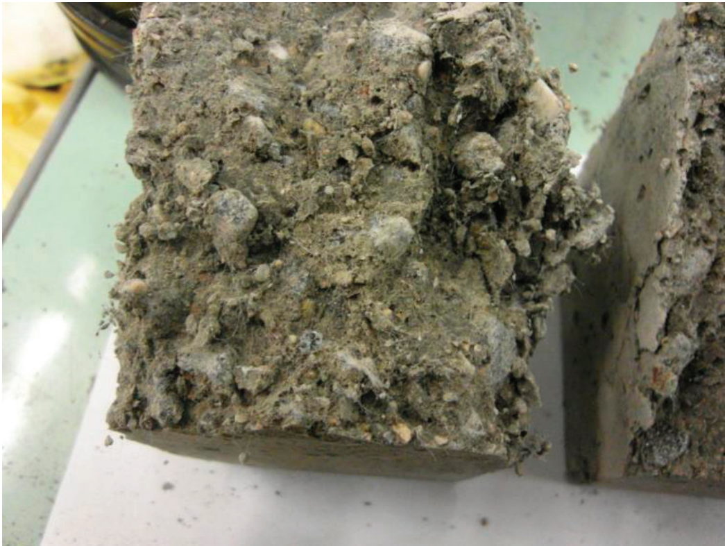
Рис. 3. Разрушенный образец с ПАН-волокном
