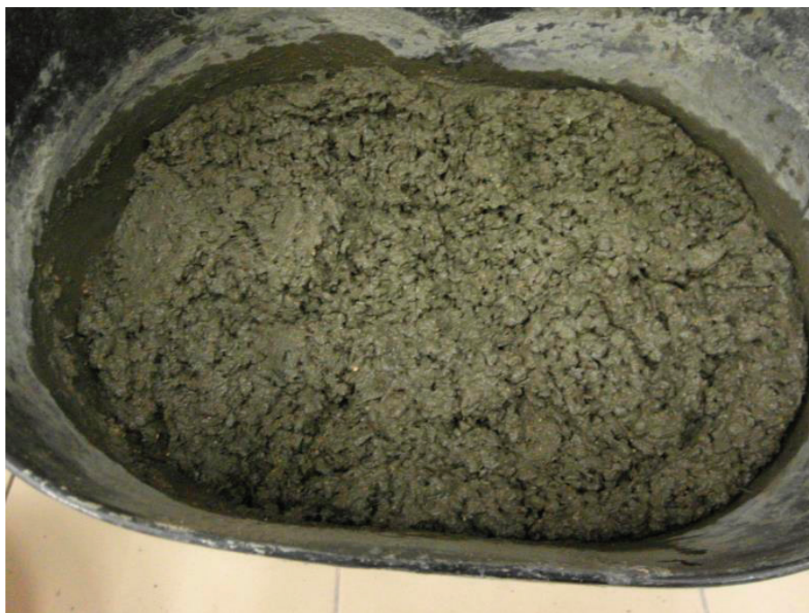
Рис. 1. Бетонная смесь с ПАН-волокном
