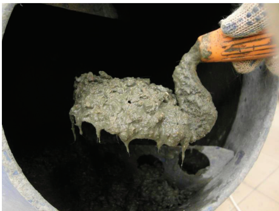
Рис. 2. Проба бетонной смеси с ПАН-волокном
