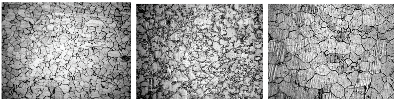
Рис. 1. Микроструктура сталей 08пс; 09Г2С; 10ХСНД (соответственно)
