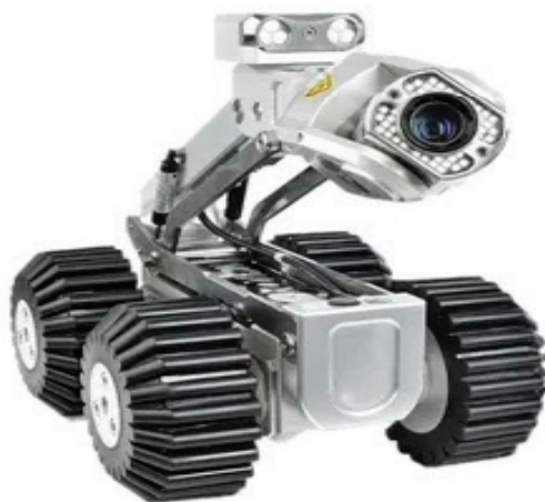
Рис. 1. Робот для диагностики и анализа магистрального трубопровода
