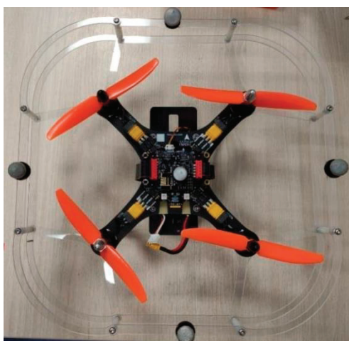
Рис. 5. Квадрокоптер с установленными на нем маркерами
