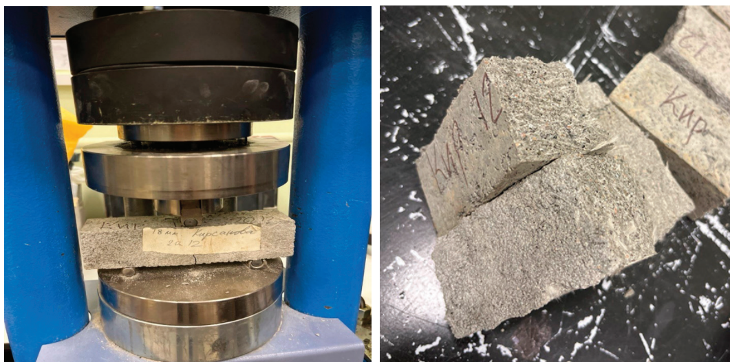
Рис. 7. Испытание на изгиб образцов на гидравлическом прессе
