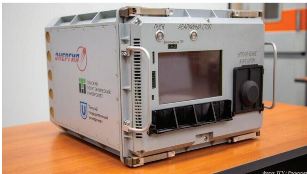
Рис. 1. Российский космический 3D-принтер, разработанный РКК «Энергия» совместно с Томским политехническим и Томским государственным университетами
