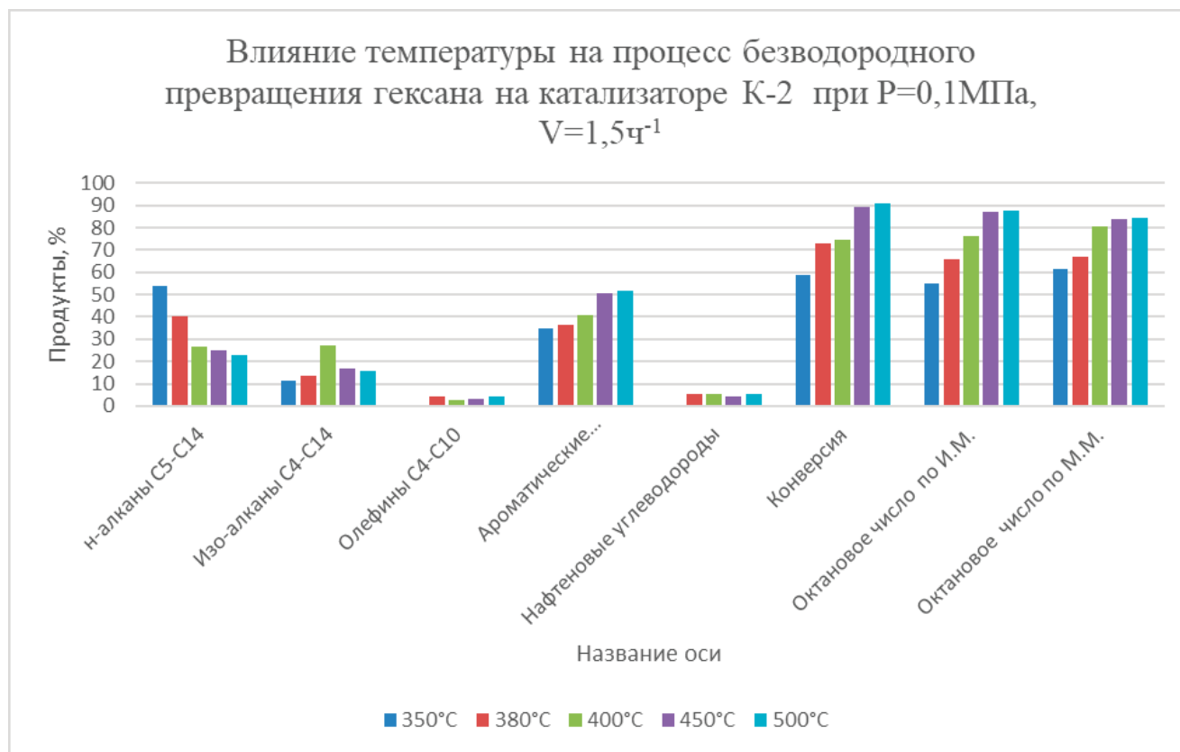
Рис. 1. Влияние температуры на процесс безводородного превращения гексана на катализаторе К-2 при P=0,1МПа, V=1,5ч -1
