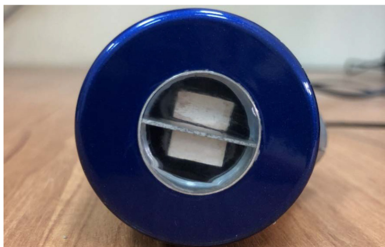
Рис. 4. Датчик 2.5 МГц прибора «БодиСоник»
