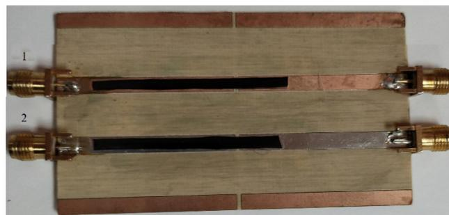
Рис. 1. Образец 1: 1 — НПЛ медь-углерод-медь; 2 — НПЛ олово — углерод-олово
