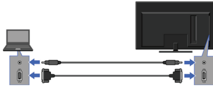
Рис. 5. Подключение источника к средству отображения напрямую
