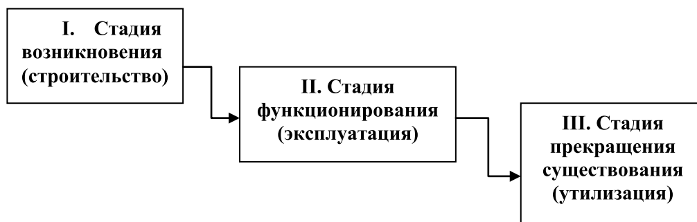
Рис. 1. Жизненный цикл здания
