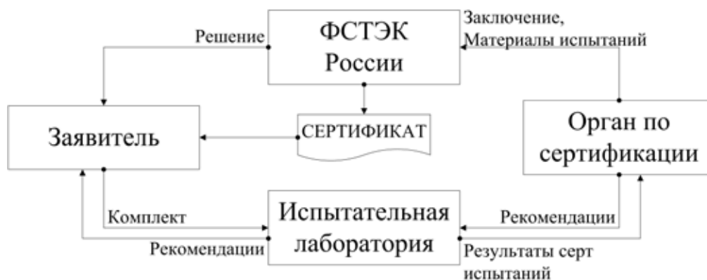
Рис. 1. Система сертификации программного обеспечения
