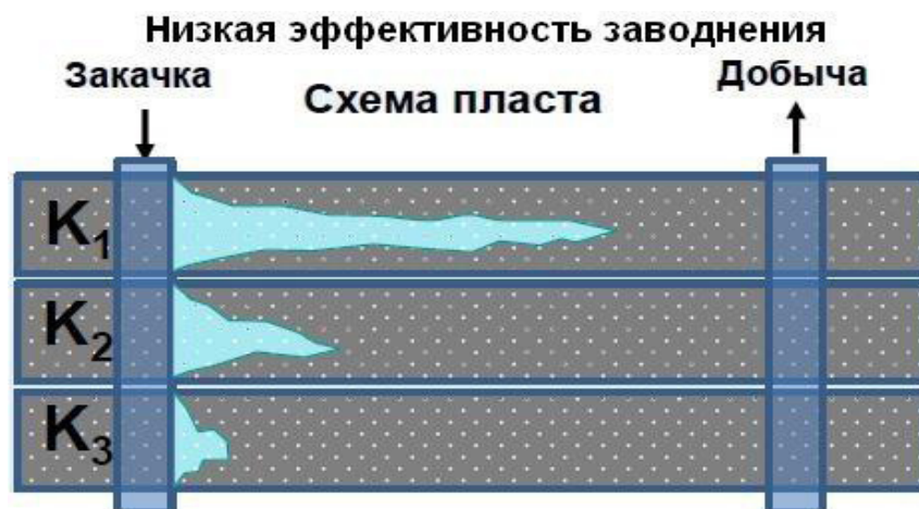
Рис. 1. Схематичное представление о распространении фронта вытеснения в условиях ярко выраженной анизотропии проницаемости пород коллекторов
