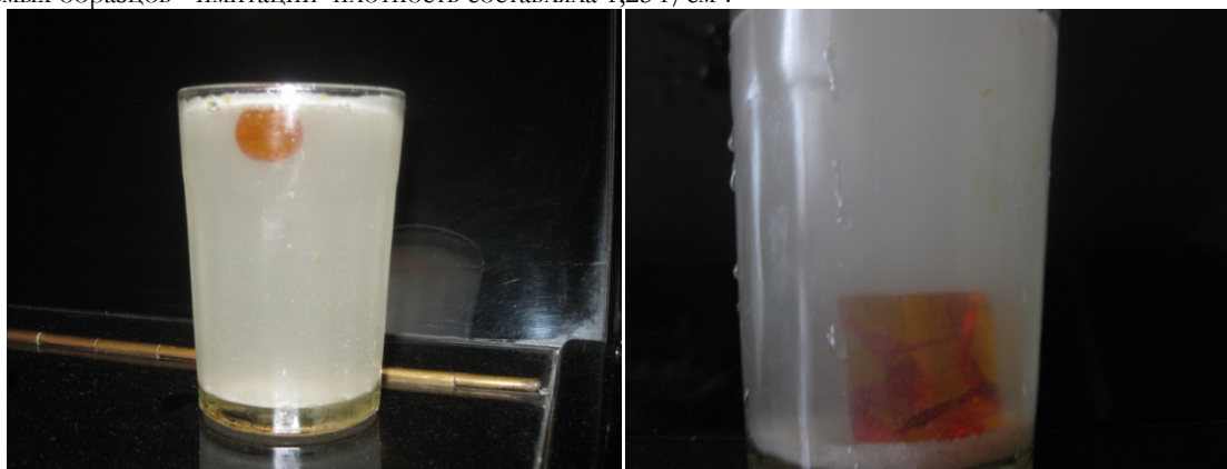
Рис.2. Поведение исследуемых образцов в растворе соли в воде: а - образец натурального янтаря; б – образец имитации янтаря
