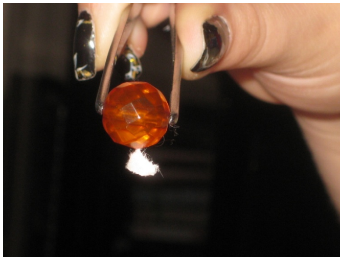
Рис. 5. Притяжение к наэлектризованному натуральному янтарию шерстяных волокон
