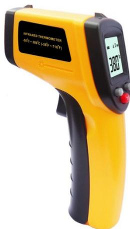
Рис. 2. Инфракрасный термометр (пирометр)
