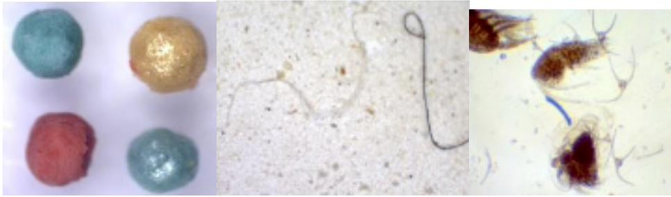
Рис. 2-4. Как должен выглядеть микропластик из водоёма согласно руководству
