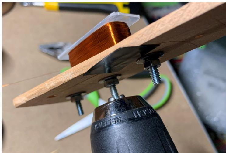
Рис. 4. Намотка катушки звукоснимателя
