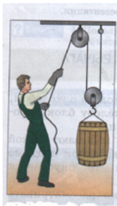
Рис. 181. Комбинация подвижных и неподвижных блоков — полиспаст» [1, с. 182].
