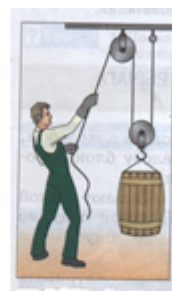
«Комбинация подвижных и неподвижных блоков- полиспаст» [1, рис.181].
