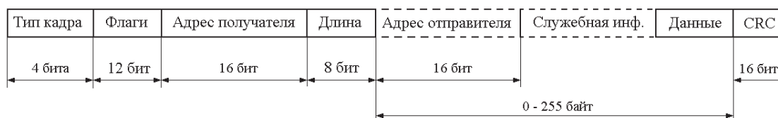
Рис. 2. Формат заголовка пакета данных
