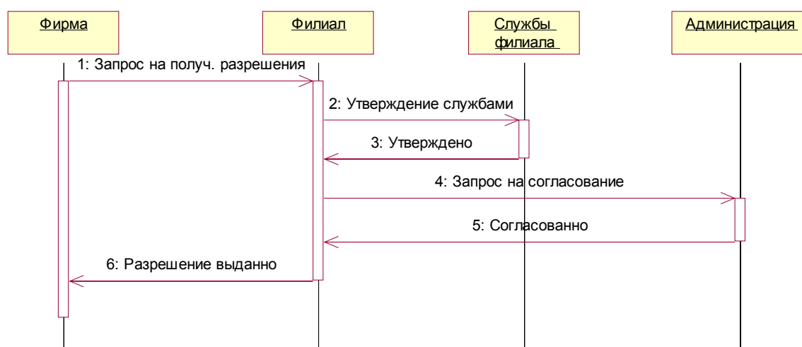
Рис. 3. Схема нового метода по организации работ в охранной зоне газопроводов
